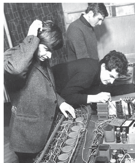
Naprawa konsoly mikserskiej. Od lewej: Mieczysław Serafin, Bogusław Maśnicki, Wojciech Andruszkiewicz (pochylony)
